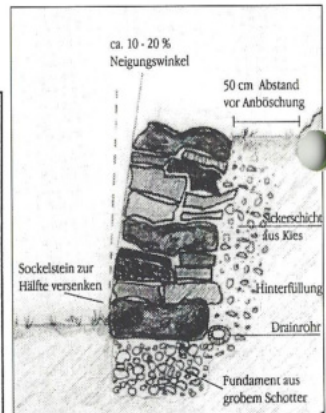
Querschnitt durch eine Stützmauer
